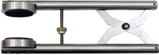
4441.1 Paralel Düzleyici pense , 1mm to 40mm Paralel pozisyonu korur, çok rahat kullanımlıdır. Değiştirilebilir grafit plakalar, Çap: 40mm, Kalınlık 10mm. Her zaman aynı aralık ve kalınlık için stop somunu.
