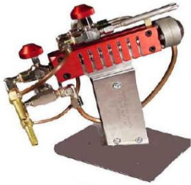
4404.2 - Büyük şaloma, 45 çıkışlı yuvarlak şaloma, ortada 16 çıkış, ayrıca 27 çıkışlı ikinci bir daire, Alev çapı 30mm. Üste 7 çıkışlı küçük çıkış, Doğal gaz Oksijen veya Propan Oksijen (Tüp veya Konsantrator).
