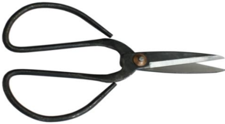
Çelik cam makasları. Küçük makaslar daha rahat kontrol edilebildiği gibi, Ergimiş camı kesmek, fazla kenarları almak için kullanılır.
