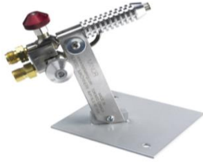
4402.1 - Küçük şaloma, Yüzeyle gaz karışımı, 7 çıkış. Doğal gaz Oksijen veya Propan Oksijen (Tüp veya Konsantrator).
