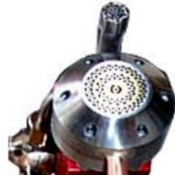
4404.2 - Büyük şaloma, 45 çıkışlı yuvarlak şaloma, ortada 16 çıkış, ayrıca 27 çıkışlı ikinci bir daire, Alev çapı 30mm. Üste 7 çıkışlı küçük çıkış, Doğal gaz Oksijen veya Propan Oksijen (Tüp veya Konsantrator).
