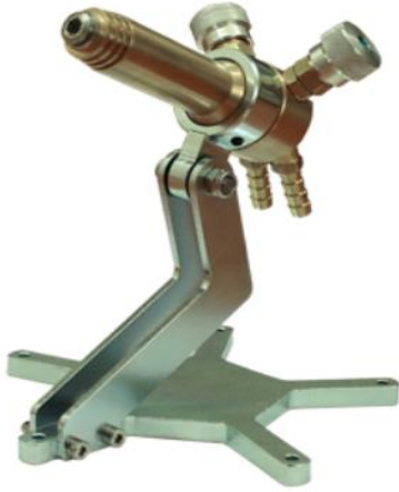
4400.7 - ANKA - Küçük şaloma, Yüzeyle gaz karışımı, 7 çıkış. Doğal gaz Oksijen veya Propan Oksijen (Tüp veya Konsantrator).
